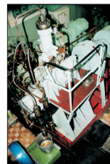
Экспериментальный стенд для тестирования топливной аппаратуры высокого давления МОД MAN B&W
